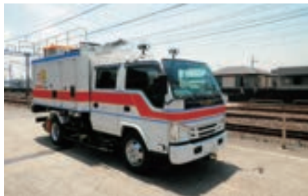
架台を格納した電気検測車
