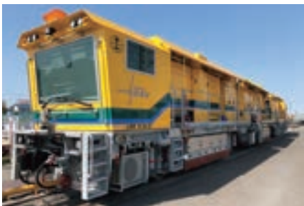
レールの表面を削るレール削正車
